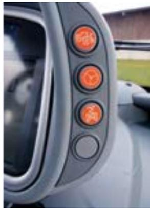
**Über drei Schaltknöpfe am Armaturenbrett können die Funktionen Streckbremse, SDD-Lenkensystem und Vorderachsfederung gewählt werden.**
