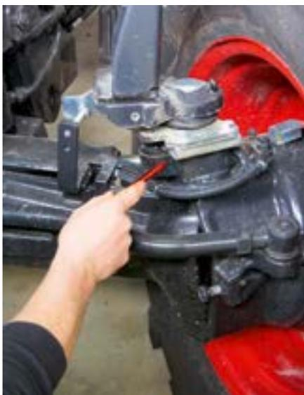
**Hier ist der Lenkwinkelsensor für das Antriebsstrang-Management (ASM) gut geschützt untergebracht.**
