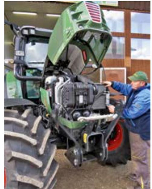
**Hervorragende Zugänglichkeit zu Motor, Lüfterpaketen und Wartungspunkten.**
