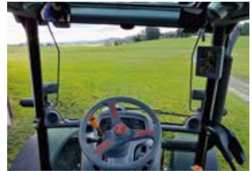
**Helle Kabine mit guter Rundumsicht: Das Abgasrohr wird rechts am Holm hochgeführt, und es gibt keinen Partikelfilter, der die Sicht behindert.**
