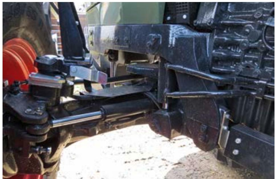
**SDF-eigene Vorderachse mit optionaler hydraulischer Federung.**
