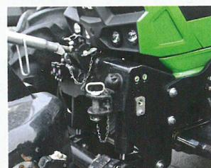
**Nicht nutzbar:** Das Zugmaul ist bei eingeklappten Unterlenkern kaum zu nutzen. Und der Splint vom Oberlenkerhalter sitzt oft im falschen Loch und verbiegt.
