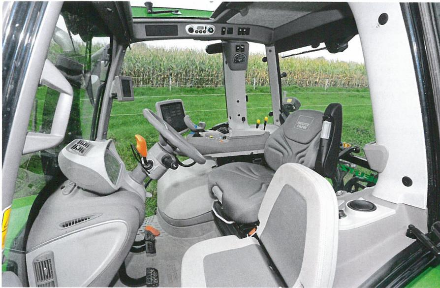
Fast 76 dB(A) sind für eine neu entwickelte Kabine viel. Der helle Bezugsstoff ist außerdem schmutzempfindlich und könnte robuster sein. Leider kann man den Sitz mit Bedienenlehne für eine bessere Sicht nach hinten nicht seitlich drehen.
