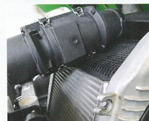
**Nicht lösbar:** Die Spangen des Luftfilters lassen sich nur bei geschwenkten Kühlern öffnen.
