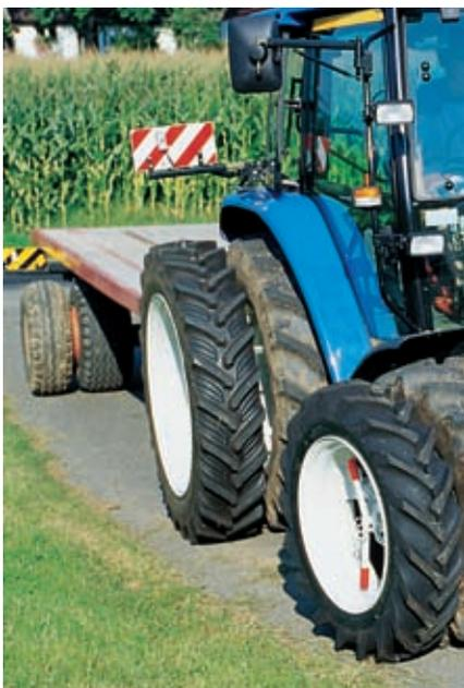
Doppelräder an Transportanhängern sind bis zur Breite des Zugfahrzeuges, max. 3 m, ohne Bewilligung erlaubt. Transportanhänger, welche mit Breitreifen mehr als 2,55 m breit sind, müssen als Ausnahmefahrzeuge mit braunem Kontrollschild eingelöst werden. Das Zugfahrzeug muss mindestens die gleiche Breite aufweisen.
