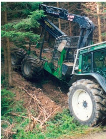
Besonders im Forst und in unwegsamem Gelände ist eine hohe Verdrehmöglichkeit zwischen Zugfahrzeug und Anhänger gefordert. Dies wird nur mit der Kugelumkupplung erreicht. Die Kugelumkupplung kann auch als Obenanhängung verwendet werden, wenn die Anhänger entsprechend ausgerüstet sind.
