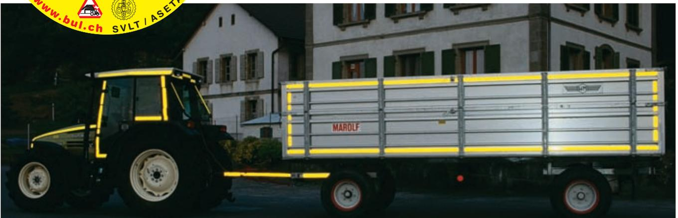
Traktoren und Anhänger sollen seitlich und hinten mit Konturmarkierung versehen werden, damit sie nachts und in der Dämmerung unübersehbar sind.
