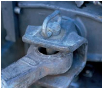
*Wenn Anhängervorrichtung und Zugöse nicht zusammenpassen, sind Unfälle und Sachschäden vorprogrammiert. Eine Schwerlastöse Ø 50 mm darf weder an einem Piton-fix noch an einem Zugmaul gekoppelt werden.*
