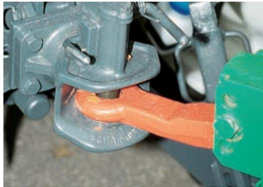
Der Stecknagel mit Sicherung muss sich leicht vom Traktorsitz aus bedienen lassen oder automatisch funktionieren. Die Gelenkwelle ist durch das Masterschild und die Kombination Zugmaul-Zugöse verdeckt.
