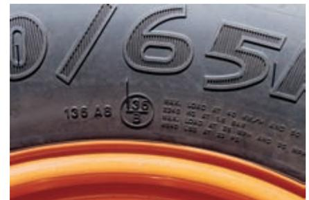
*Um die maximalen Lasten ausnutzen zu können, müssen sowohl Reifen als auch Achsen usw. die nötigen Anforderungen erfüllen. Die Reifenhersteller können Angaben zu den Kennzahlen liefern.*
