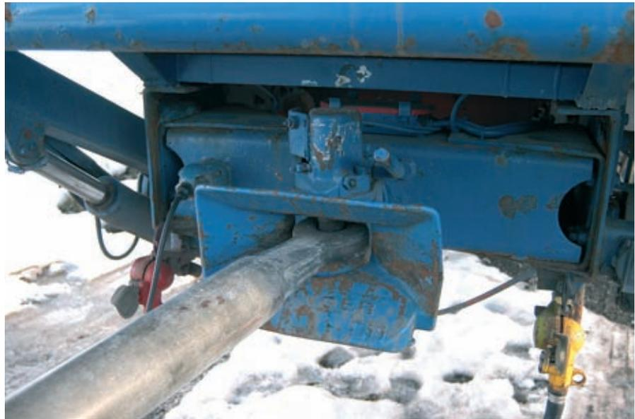
Die Kugelpkupplung ist auch für Obenanhängung geeignet. Dies bedingt, dass alle Anhänger mit Kugelzugöse ausgerüstet sind.
